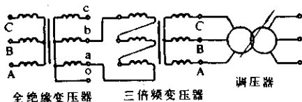
图 112—3 三倍频变压器对全绝缘变 压器(A、B相)做感应耐压试验
